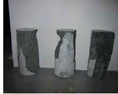
強度試験後の破壊状況
