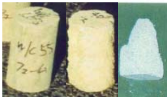
高炉フューム 30% 高炉スラグ微粉末50% シリカフューム 10%
