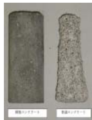
希硫酸浸漬試験 濃度 10%
